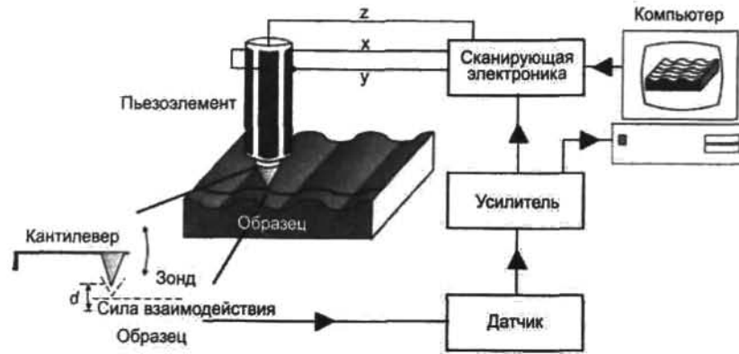
Рис. 6.17. Схема строения сканирующего атомно-силового микроскопа. В отличие от общей схемы (рис. 6.8), зонд представляет некий гибкий элемент (консоль, рычаг, кантилевер), способный при достаточно маленьком расстоянии над поверхностью образца в статическом состоянии или при возбуждении резонансной частотой регистрировать силы межатомного взаимодействия. В особых режимах эксплуатации микроскопа, между зондом и образцом специально допускается временный или длительный контакт
