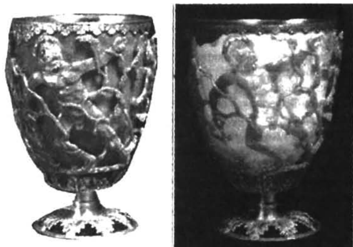
Рис. 2.3. Кубок Ликурга (4 век, Национальный Британский исторический музей). Бокал, на который нанесены частицы размером в 70 нм (содержащие семь частей серебра и три части золота), кажется зеленым в отраженном свете и красным при подсветке сзади
