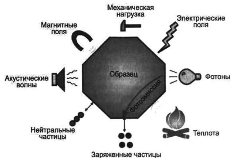
Рис. 6.1. Основа любого анализа — реакция образца на внешние воздействия в виде освещения, магнитных полей, механических нагрузок и т. п. Реакция выражается в изменении свойств, излучении фотонов (электромагнитных волн), изменении температуры и т. п. Выбранная комбинация регистрируемых реакций образца на внешние воздействия определяет выбор соответствующего аналитического метода
