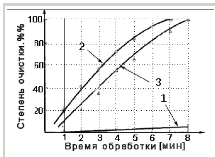
Рис.56. Очистка деталей в хлорбензоле и в композиции из хлорбензола и 20% четыреххлористого углерода:
