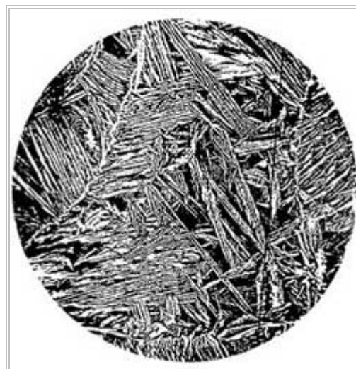
Рис. 49. Закаленный сплав меди BrAЖN10-4-4 x200
