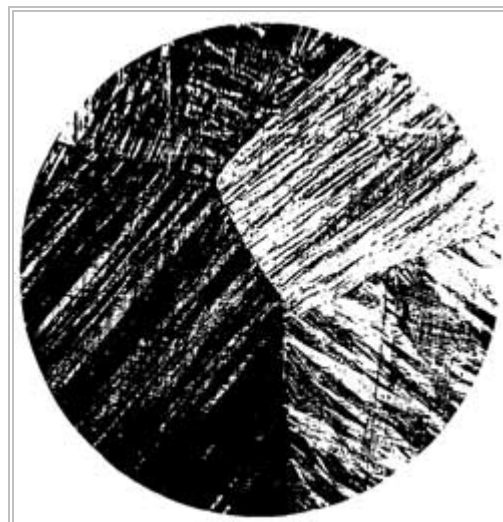
Рис.51. Закаленный сплав меди с 12Al x 200
