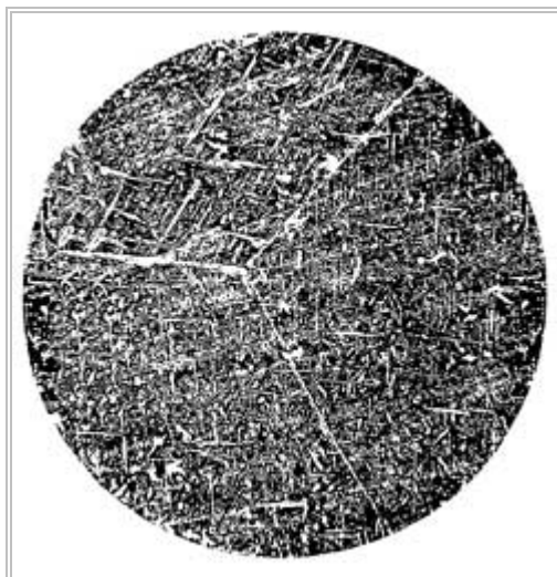
Рис. 50. Закаленный сплав меди с 10% Al и 1% Ti x 200.
