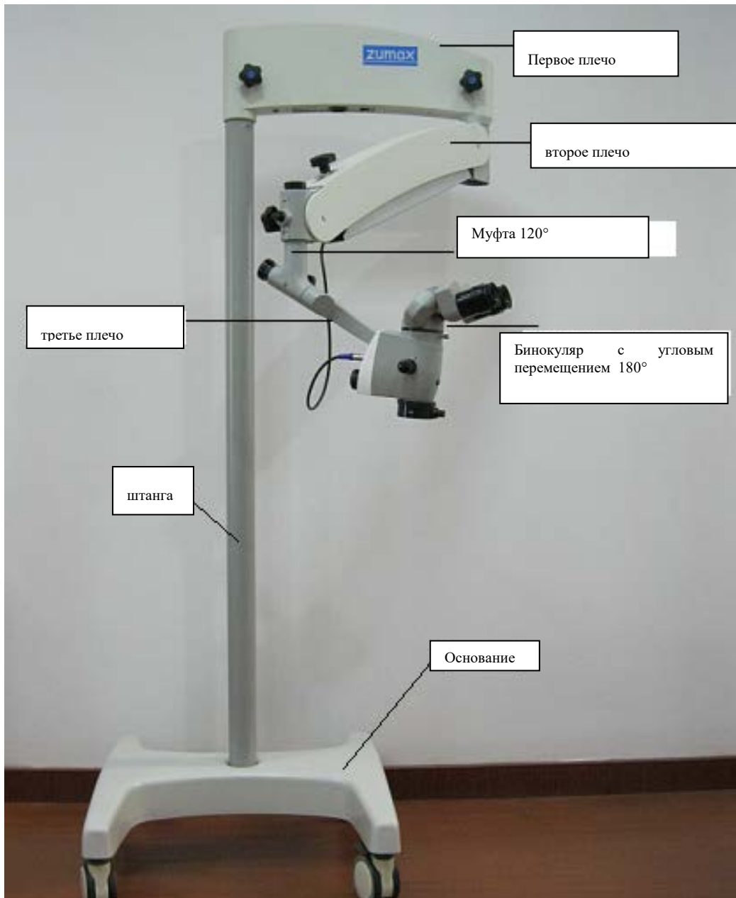
Рис. 4 Схема сборки микроскопа
