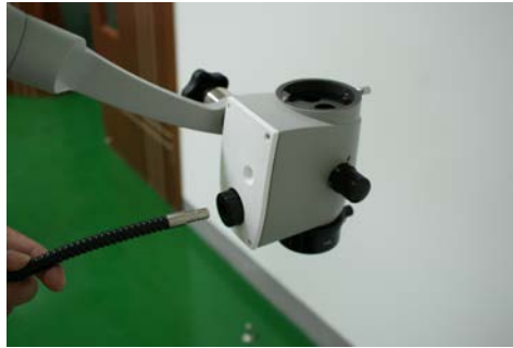
Рис.12 Подключение шнура питания
