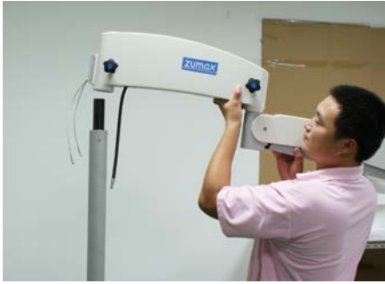
Рис.7 Установка плеча на ось штанги
