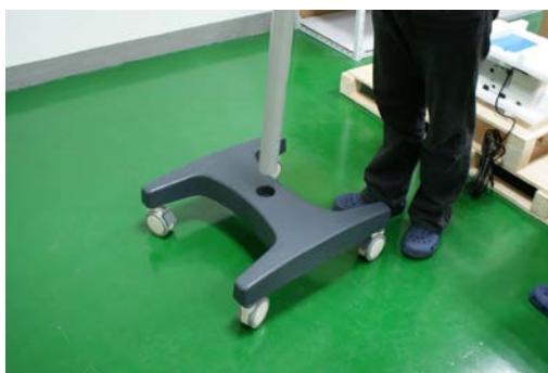
Рис.5 Установка штанги на панель основания
