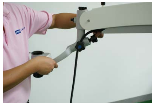
Рис.11 Крепление третьего плеча
